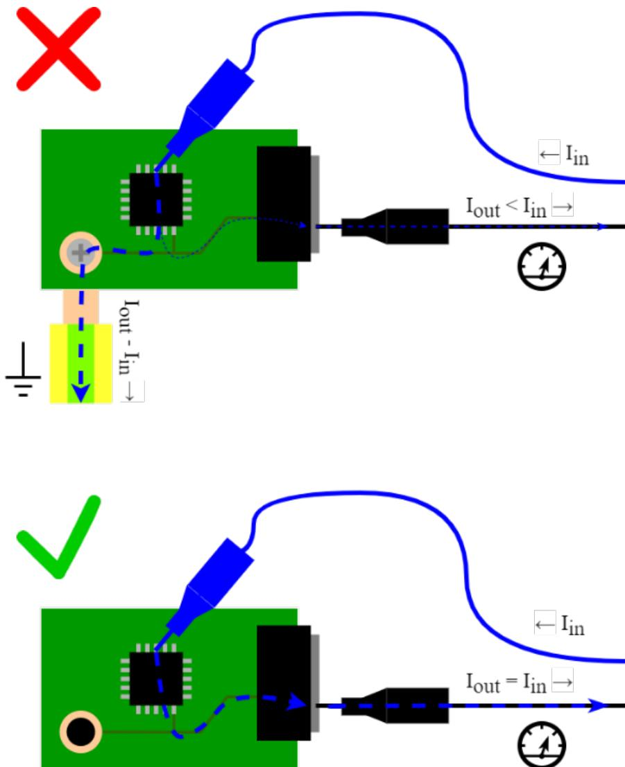
Рисунок 5. Протекание тока при неправильном подключении с использованием заземления и корректном подключении без заземления платы
