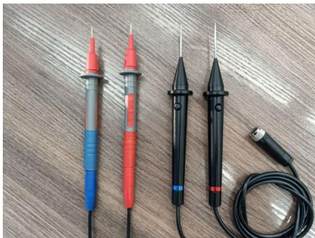
Рисунок 10.1 – Внешний вид щупов SMA (слева) и щупов с кнопкой M8 (справа)
