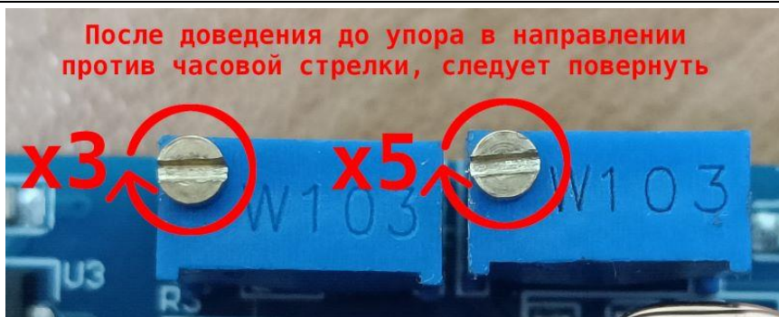
Рисунок 2.11 - Перевод потенциометров в стандартное состояние.
