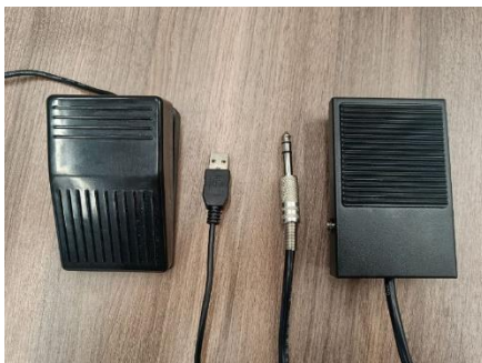
Рисунок 10.2 – Внешний вид педалей для приборов EyePoint серии «u» (слева), серии «S» (справа).
