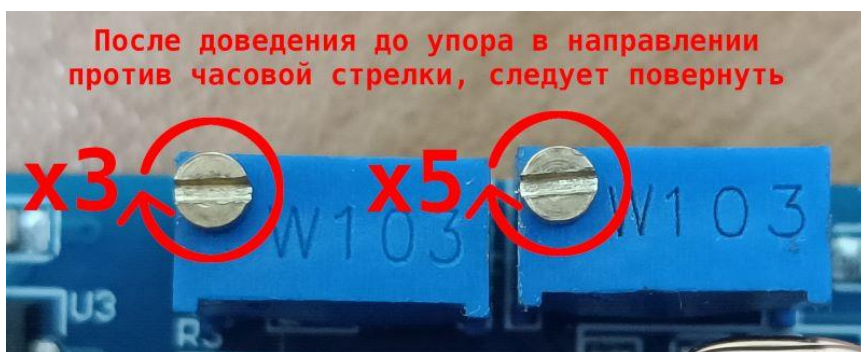
Рисунок 5.6 - Перевод потенциометров в стандартное состояние.
