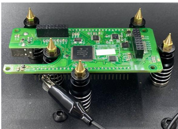
Рисунок 2. Пример фиксации платы с помощью магнитных стоек.
