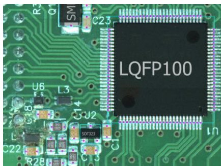
Результат работы автоматического детектора контактных площадок электронных компонентов
