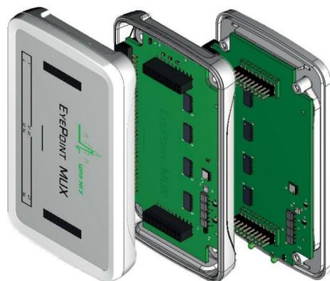
**Модуль** мультиплексора на 64 канала
